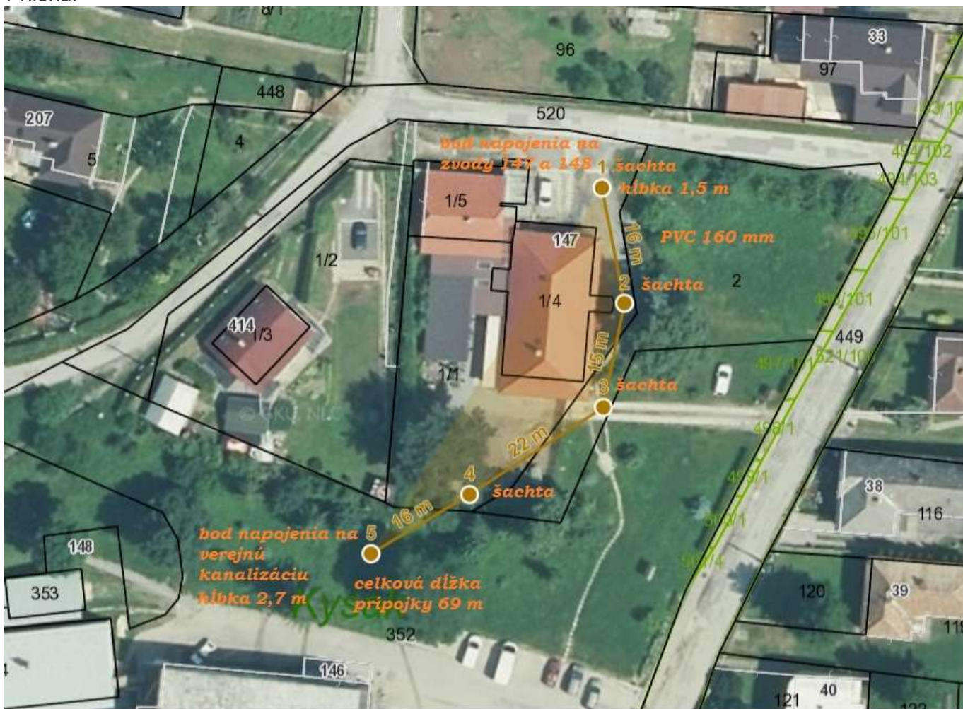
situácia kanalizačnej prípojky pre objekty na parcelách 1/4 a 1/5
